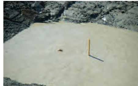
Pas de perte d'eau significative : test d'étanchéité concluant.
